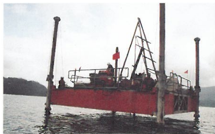
写真1 山中湖湖底ボーリングコアの掘削風景
