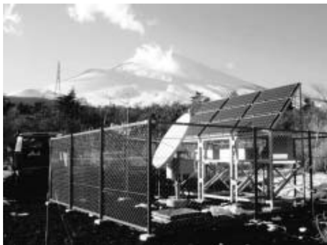
図 6 衛星テレメータを使用した臨時地震観測点。 Fig. 6. Temporal seismic observation point using satellite telemeter system.
