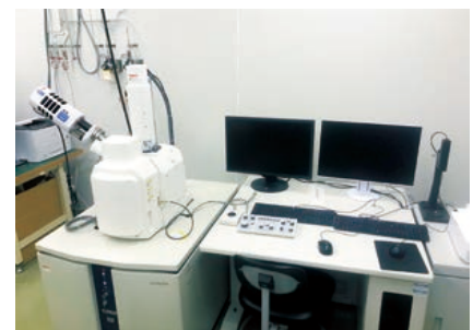
写真2 電子顕微鏡とX線分析装置（SEM-EDSシステム） スコリアや火山灰の主成分化学組成の測定に使用
