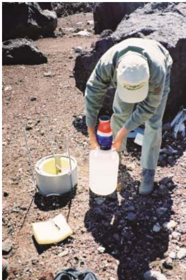
図 13 富士山頂の降水採取装置 (図 11 の地点 A) からの試料水の回収作業風景 . 降水採取装置には直径 7 cm のロートが取り付けられている . また , 同装置には , 集まった試料からの蒸発が最小限となるような工夫がされている . 試料の回収時には水量の計測も併せて行った .
