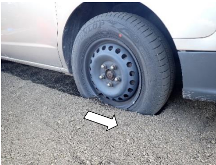
図 3. 降灰路面を走行しスタックした車両の駆動輪。タイヤの高さの半分以上が火山灰層に沈み込んでいる。火山灰の厚さ約 20 cm、試験車両は No. 8、夏用タイヤを装着。矢印は車両の進行方向。
