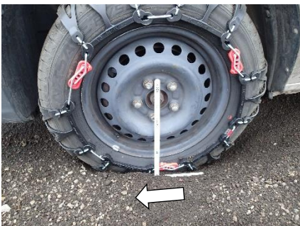
図 5. 樹脂製タイヤチェーンを装着して降灰路面を走行しスタックした車両の駆動輪。非装着時と同様にタイヤが降灰路面に沈み込んでいる。走破距離はタイヤチェーン非装着時と比べほぼ同じか短くなった。試験車両と試験路は図 3 と同じ。
